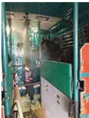
図5 馬運車内での超音波噴霧器による微酸性次亜塩素酸水の噴霧
